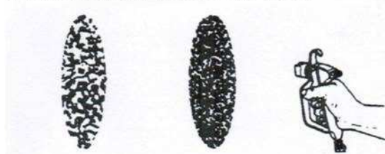
Плохая покраска Хорошая покраска
